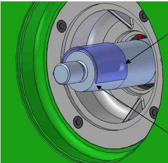
**Appliquer de la Molykote afin de réduire le frottement des anneaux joints**
