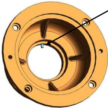
Ne pas oublier la mise en place de la cheville de fixation pour la **contre-bague** dans l'élément porteur de la garniture mécanique
