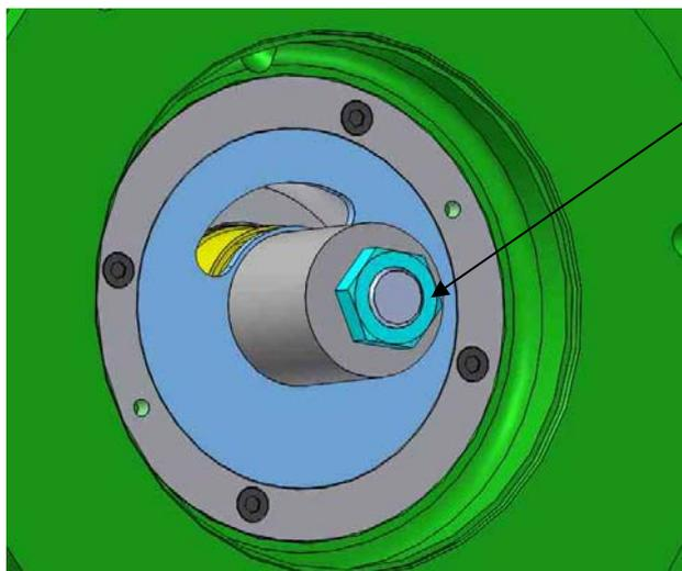
Monter l'écrou pour fixer la douille d'écartement -
