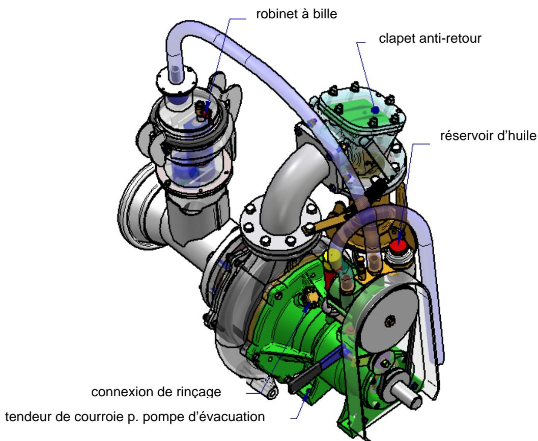
La **pompe centrifuge** n'arrive pas à aspirer le liquide (eau ou lisier) automatiquement – il en faut le système auto-amorçant.
