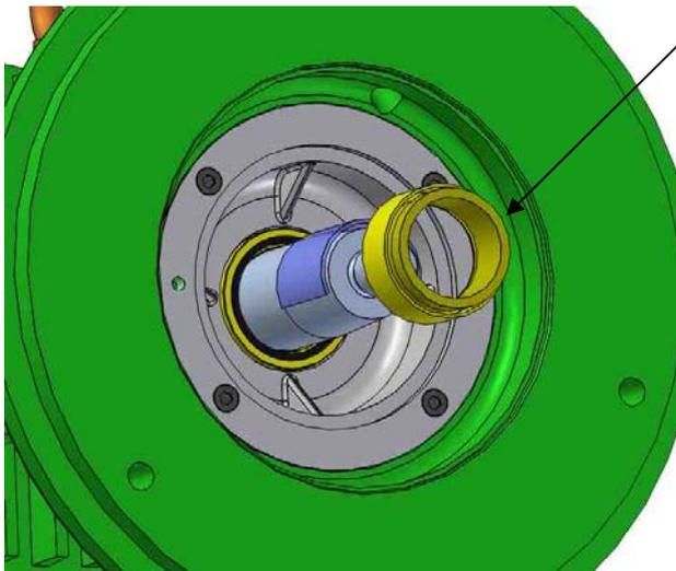
Mettre en place la garniture mécanique
